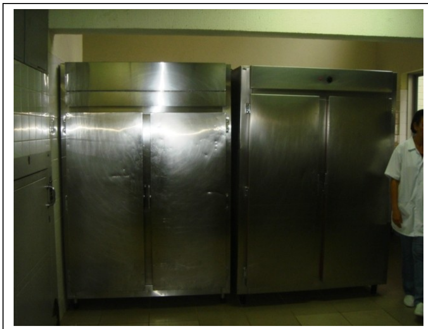
Figura 4: Pass through , equipamento utilizado para armazenamento de alimentos frios e quentes durante o período da distribuição das refeições.
